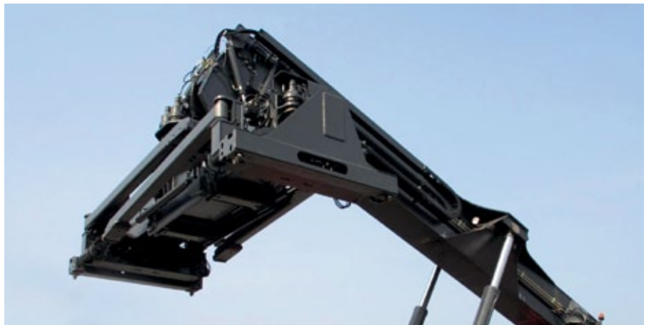
Aufgrund der dauergeschmierten Gleitplatten bedarf der Ausleger einer minimalen Wartung.
